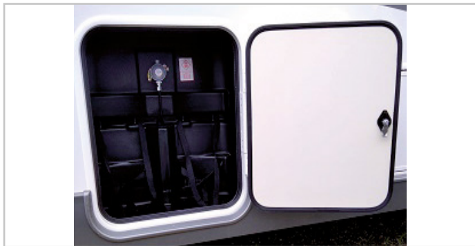
Fig.6.26 - Gasflaskfack
