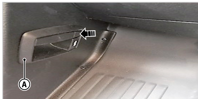
Sl.5.9 – Ročica za odpiranje pokrova motorja – tip B
