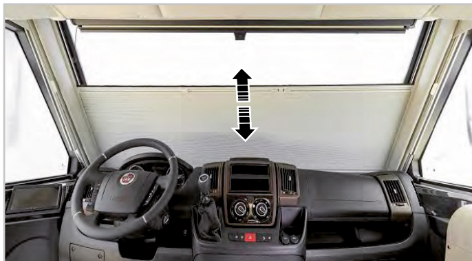
Sl.6.12 – Zložljiva zatemnitvena zavesa za vetrobransko steklo
