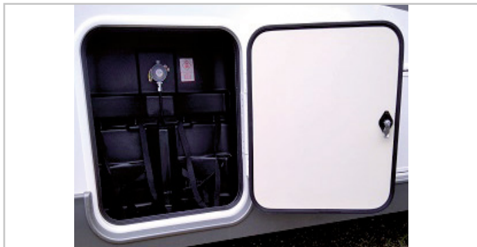
Rys.6.26 - Wnęka na butle gazowe
