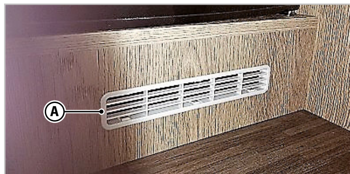
Rys.6.1 - Stałe otwory wentylacyjne
