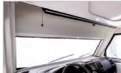
Afbeelding.6.13 - Posities van de zonweringen op de voorruit
